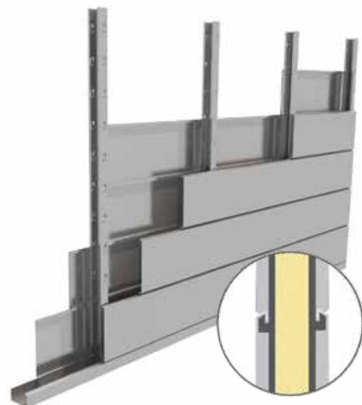
Grâce à l'espace libre entre la paroi intérieure et la paroi extérieure, il est possible de facilement y intégrer de l'isolation et des raccords !
