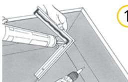
1 Finir les bords au moyen d'un profil de finition universel selon la méthode de superposition.
