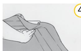
4 Plier la membrane **EPDM** dans les coins en forme de pointe.
