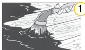
1 Le support sec doit être exempt de saleté, de poussière, de graisse, d'élément tranchant et autres qui pourraient causer des dégâts à la toiture **EPDM** ou empêcher une adhérence optimale de la **COLLE EPDM**. Impregner le support avec **SPECIAL PRIMER EPDM**, **PRIMER-TOITURE SBS** ou **ROOFPRIMER** à raison d'env. 5 m<sup>2</sup>/L. Utiliser pour se faire une brosse ou un rouleau et prévoir un temps de séchage d'env. 3 heures.
