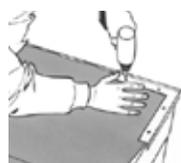
2 Appliquer et fixer les coins préformés et les profils en aluminium. Consulter les instructions dans la rubrique "Finition des bords suivant la méthode de superposition".
