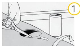
1 Découper le diamètre de la cheminée de toiture ronde dans la membrane et la faire passer sur le conduit. Pour la finition, utiliser la manchette universelle. Les manchettes servent à la finition parfaitement étanche des buses rondes comme les buses d'aération et de ventilation et ce de manière très simple.
