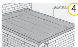
4 Vérifier que la membrane soit bien répartie sur la surface totale et dépasse des bords du toit de manière égale. Laisser maintenant la toiture en caoutchouc "reposer" environ une heure afin de neutraliser les tensions inhérentes à sa fabrication.
