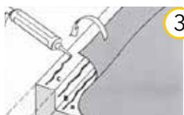
3 Appliquer un trait de **COLLE EPDM** sur la toiture, juste devant le relevé. Poser la membrane dans la colle et compresser fortement. Appliquer ensuite un trait de **COLLE EPDM** sur le relevé vertical et un sur le rebord du toit. Poser la membrane dans la colle et compresser fortement.
