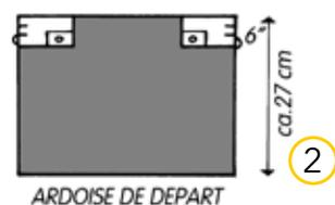
Préparez l'ardoise de départ en traçant une ligne horizontale sur l'ardoise au niveau du point de marquage 6" (= env. 27,5 cm du bas de l'ardoise) et découpez celle-ci à l'aide d'une disceuse munie d'un disque pour pierre.
