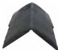
Utilisez pour la finition du faîtage les faîtières **ARDOISE-RUSTIQUE**. Préparez les faîtières en découpant en biais la partie non visible des deux côtés de la faîtière, au moyen d'une scie, d'un cutter ou d'une disqueuse.
