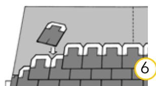
Pour la pose des rangées d'ardoises suivantes, commencez avec une ardoise de part et d'autre du trait de craie vertical. La ligne de marquage choisie correspond toujours avec le dessus de l'ardoise recouverte. Poursuivez ainsi vers l'extérieur. L'ardoise extérieure est marquée d'un trait à mesure, disquée et vissée. Pour la rangée suivante vous posez à nouveau le milieu de la première ardoise sur le trait de craie.
