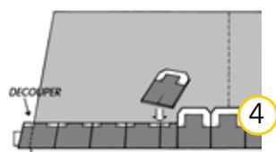
La première rangée d'ardoises est obtenue en vissant une ardoise complète sur l'ardoise de départ et en veillant à ce que le milieu de l'ardoise concorde avec le trait de craie vertical. Vérifiez que le dessous des ardoises soit au même niveau. Terminez la première rangée en partant du milieu vers les bords du toit.
