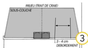
Posez les ardoises de départ en vissant les 2 premières ardoises de départ de part et d'autre du trait de craie. Utilisez les orifices prévus (marquage clou/"nail"). Prévoyez un débordement de max. 3 à 4 cm. Posez les ardoises de départ suivantes l'une à côté de l'autre, de sorte que le bord d'une ardoise soit en contact avec le côté de l'autre ardoise.
