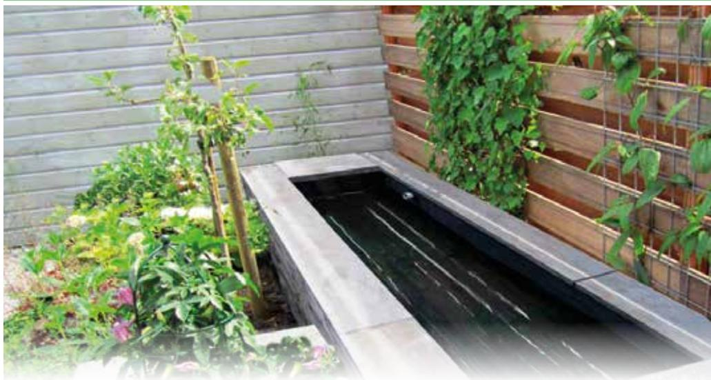
Caoutchouc synthétique de qualité, composé d'une seule pièce et d'une seule couche. La membrane pour étang est extrêmement élastique et peut être étirée jusqu'à plus de 400 %. Elle s'adapte ainsi facilement aux supports irréguliers.
