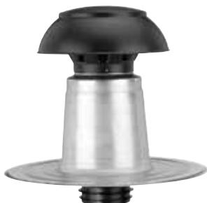
Ventilation optimale des toitures plates, munie d'une embase spéciale préformée en aluminium et d'un chapeau en polypropylène résistant aux chocs et aux UV. La forme spécifique permet une bonne évacuation de la condensation et empêche la pluie d'entrer.
