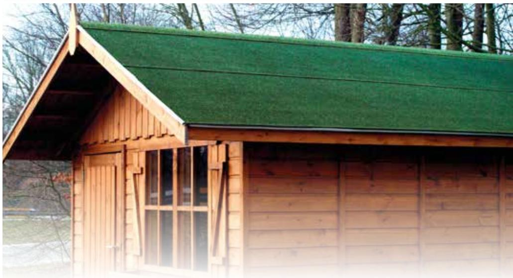
Membrane décorative étanche, à coller ou à souder, renforcée à l'aide d'une armature en polyester indéchirable et imputrescible et finie au moyen de granulats de couleur. Le dessous est muni d'un film MMP perforé qui permet une pose sur une toiture neuve ou existante.
